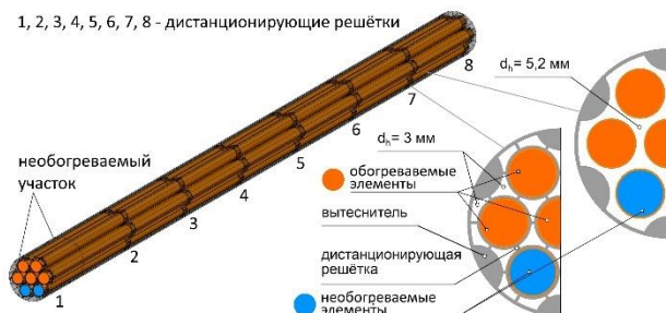
Рис. 1. Геометрия моделируемой сборки и поперечное сечение расчетной области в зоне дистанционирующих решеток и между ними, указаны гидравлические диаметры межтрубных квазитреугольных каналов.
