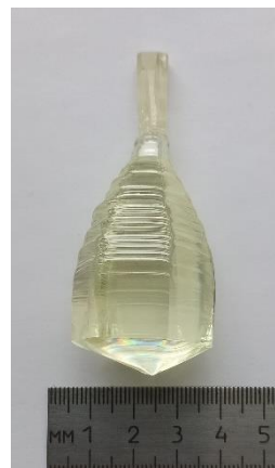
Рис. 1. Монокристалл \text{NaCsMo}_3\text{O}_{10} , выращенного в направлении [001] .
